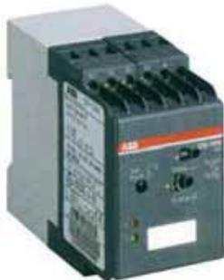
El control de aislamiento CM-IWN-AC, permite detectar el primer fallo de aislamiento en sistemas AC sin tierra. Su principio de medida se basa en controlar la resistencia contra tierra, para ello una tensión DC se inyecta al sistema.
